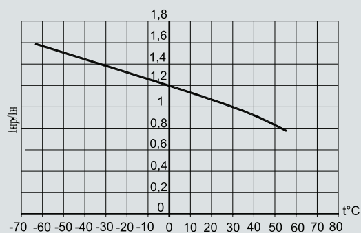
Зависимость номинального рабочего тока выключателей от температуры окружающего воздуха
